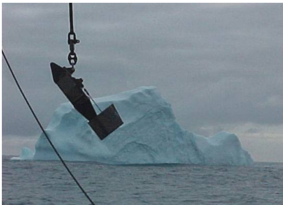
El registrador de plancton justo antes de ser sumergido en el mar. / Sir Alister Hardy Foundation for Ocean Science (SAHFOS)
