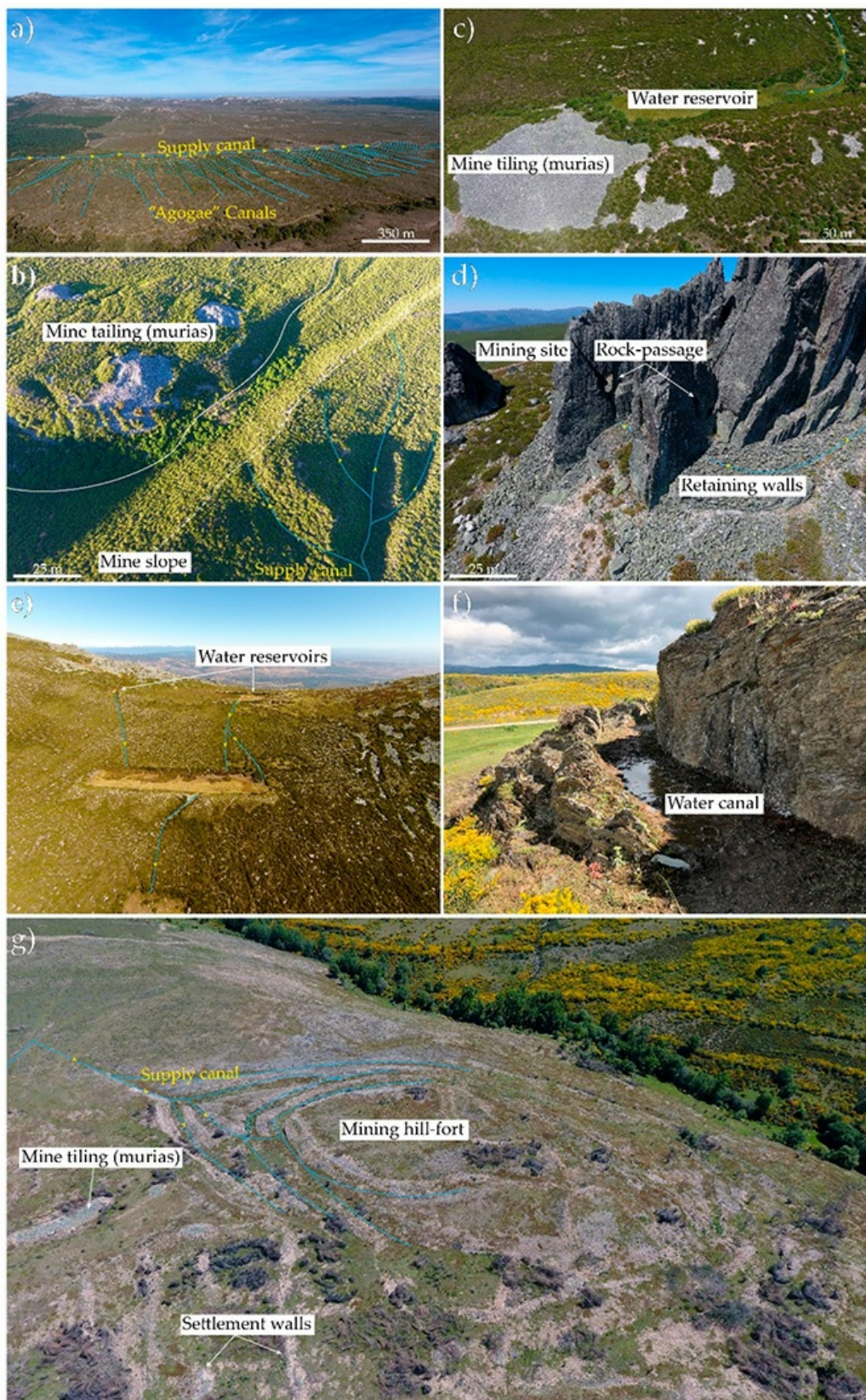
Imágenes aéreas de los siete sectores de estudio: mina a cielo abierto en forma de peine (a), otra más profunda (b), depósitos de murias con reservorio de agua (c), túnel de roca (d), reservorios
