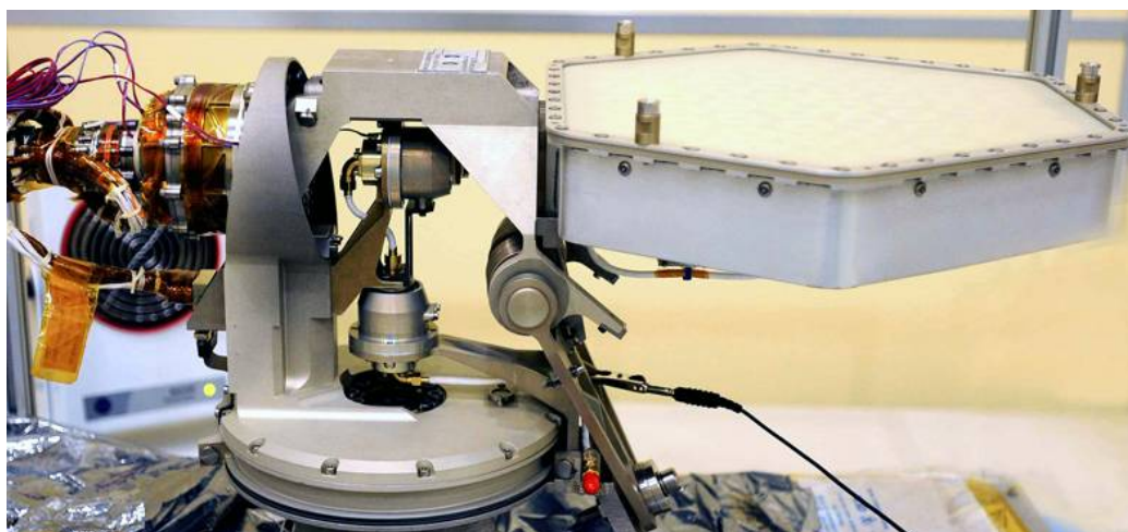
Antena de comunicación HGA. Imagen: CAB.
