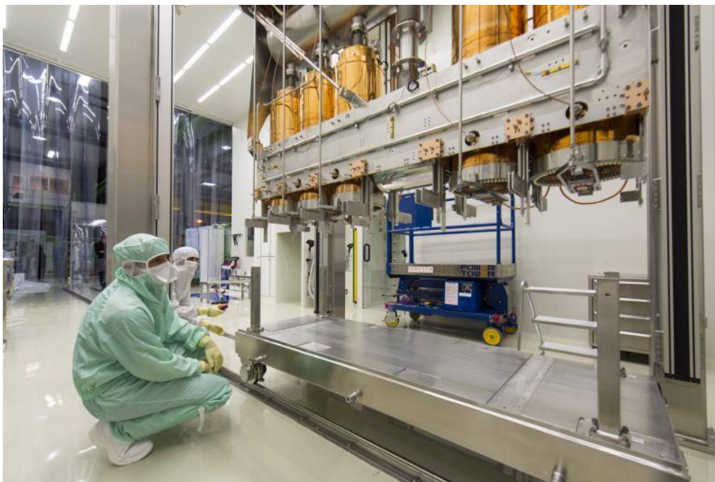
Ensamblaje del módulo superconductor de aceleración de ISOLDE en la sala blanca del CERN. / Maximilien Brice/CERN
